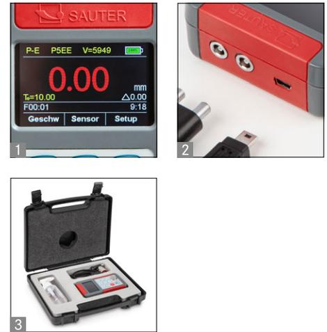
Mesureur d'épaisseur de matériau ultrasonique portable de haute gamme par procede echo-echo
