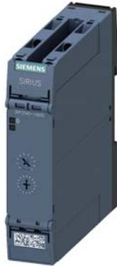
Zeitrelais, elektronisch rückfallverzögert ohne Steuersignal oder ablaufischer einschaltwischend nullspannungssicher AC/DC 24 V, 1 Wechsler 7 Zeitbereiche, 0,05...600 s mit LED, Schraubanschluss
